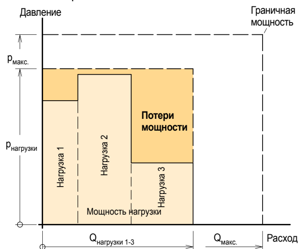
Диаграмма 2. Система с постоянным расходом с регулируемым насосом (например, VP1).
