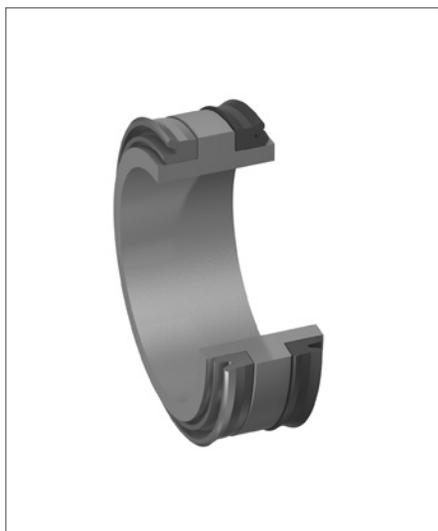
Набор уплотнений Ultrathan® профиля KS был разработан специально для уплотнения поршней в гидравлических аккумуляторах с двойными средами. Он состоит из двух U-образных колец разной геометрии и материала. Форма уплотнений делает их идеальными для постоянного разделения сред под давлением, например газа и масла, с низкой силой трения.
