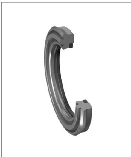
Уплотнение штока Ultrathan® профиля BU — это компактная манжета с интегрированным антиэкструзионным кольцом. Обычное применение уплотнения этого профиля — буферное уплотнение в системах уплотнения гидроцилиндрах строительной техники. Данные цилиндры функционируют в экстремальных условиях, где обычным явлением является давления до 1 000 бар.
