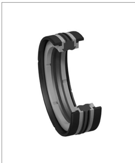
Комплект уплотнений поршня двойного действия профиля ZW состоит из уплотнительного элемента из эластомера, двух анти-экструзионных и двух опорно-направляющих углообразной формы колец.
