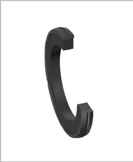
Набор уплотнений поршня Ultrathan® профиля KR дополняет линейку уплотнений поршня двойного действия (OE, OK) для установки в посадочные канавки в соответствии со стандартами ISO 7425-1 и, которое предпочтительно используется в диапазоне давления до 300 бар. Это уплотнение состоит из профильного кольца из недавно разработанного полиуретана с улучшенными свойствами скольжения и кольца предварительного натяжения с прямоугольным сечением из нитрил-каучукового эластомера.
