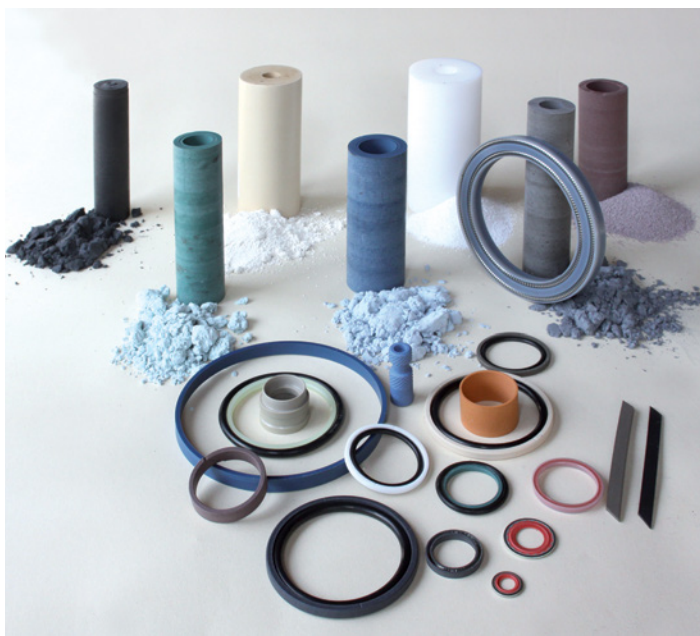
Рис. 1.3 Порошкообразный политетрафторэтилен, форма заготовки и окончательно обработанное изделие
