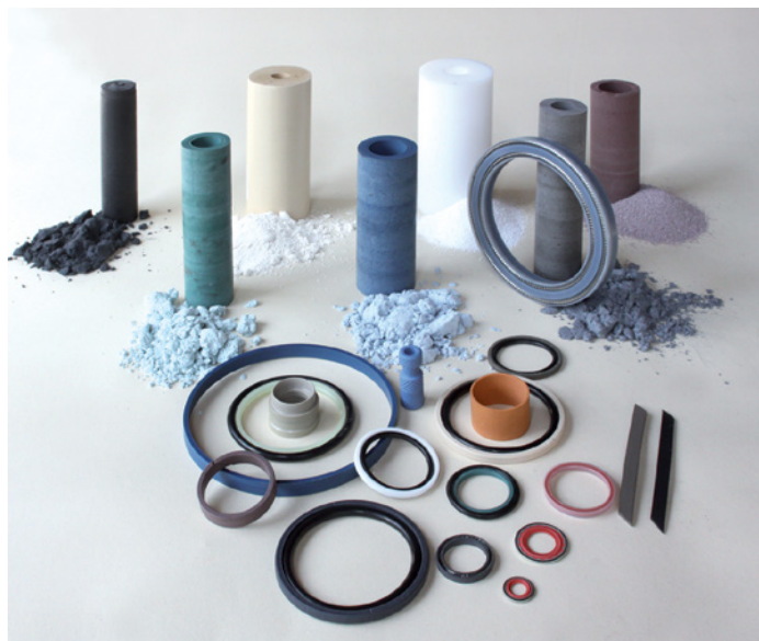
Порошкообразный политетрафторэтилен, форма заготовки и окончательно обработанное изделие
