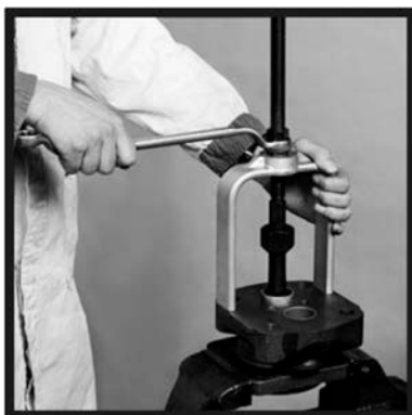
9) Проверить все втулки на задиры или следы перегрева. При необходимости выполнить замену. Снятие втулок с помощью выталкивателя представляет сложность. Рекомендуется выполнить замену на новый фланец или корпус с уже установленными втулками.
