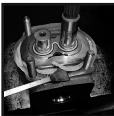
9) Проверить все втулки на задиры или следы перегрева. При необходимости выполнить замену. Снятие втулок с помощью выталкивателя представляет сложность. Рекомендуется выполнить замену на новый фланец или корпус с уже установленными втулками.
