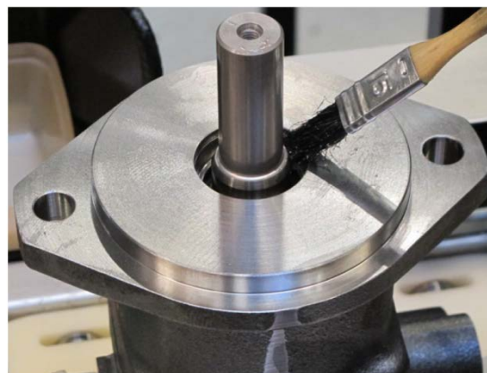
18. Перед сборкой уплотнения вала смазать уплотнительную поверхность на валу.
