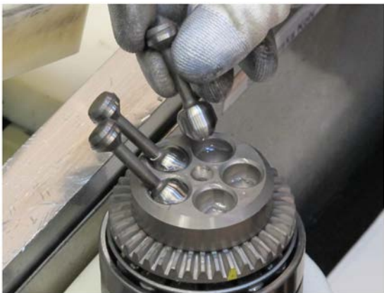
14. Установить поршни. Перед сборкой смазать гнезда поршней.
