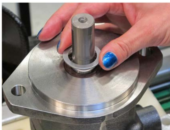
20. Установить опорное кольцо фаской на пылезащитную кромку уплотнения вала.
