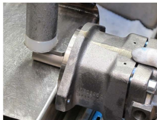
24. Осторожным постукиванием вбить шпонку в паз и повернуть вал не менее чем на один оборот. Проверить правильность бокового зазора шестерен (см. стр. 12).
