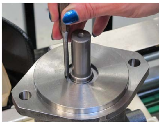
21. Осторожным постукиванием осадить уплотнение вала и опорное кольцо.
