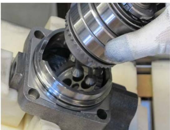
15. Установить вал в сборе вместе с поршнями в блок цилиндров.
