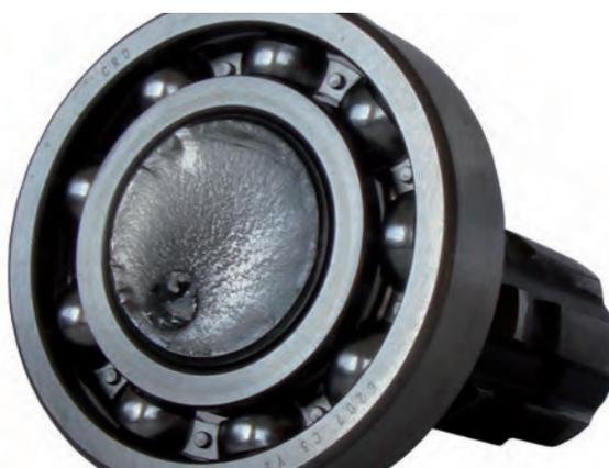
**Вращательное усталостное разрушение при изгибе**
