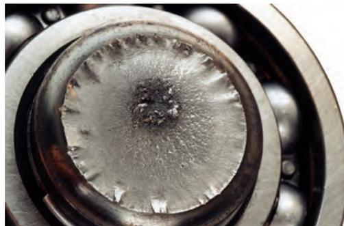
• Деформированный вал, часто при высокой частоте циклов.
