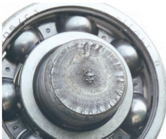
**Вращательное усталостное разрушение при изгибе**
