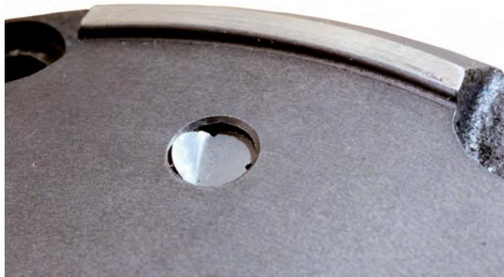
В долгосрочной перспективе это приведет к усталостному разрушению. Сумма превышений допустимых пределов ослабит механическую прочность компонентов. Такие специфические отказы могут наблюдаться на следующих деталях: статорное кольцо, пластины, вал, боковые крышки, шлицы ротора или разрыв ротора между двумя пазами для пластин.
