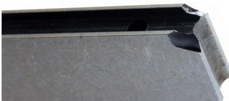
Разбалансировка пластин вызывает очень высокие мгновенные ускорения штифтов. Штифты бьют по кольцу внутри ротора вплоть до его окончательного разрушения.
